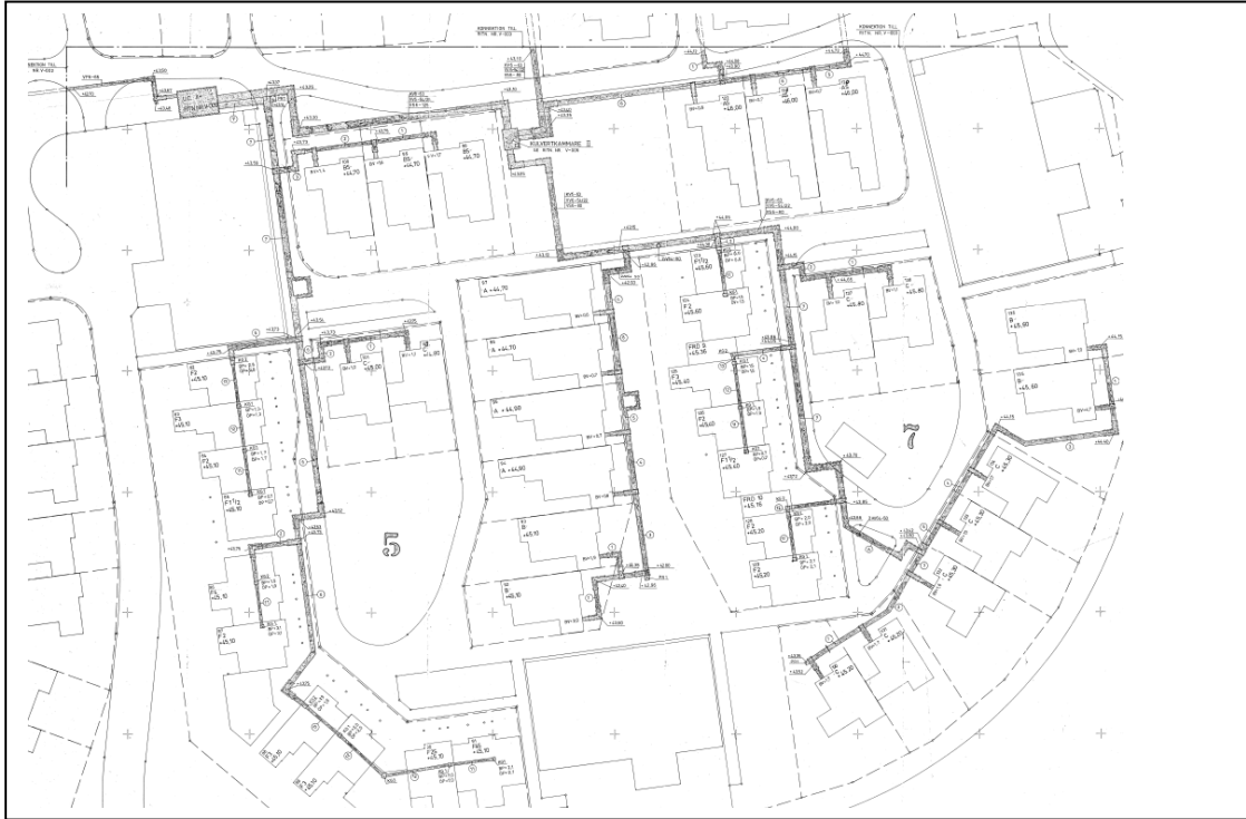
Kulvertledning Delområde 5 och 7 Kragstalund 2
